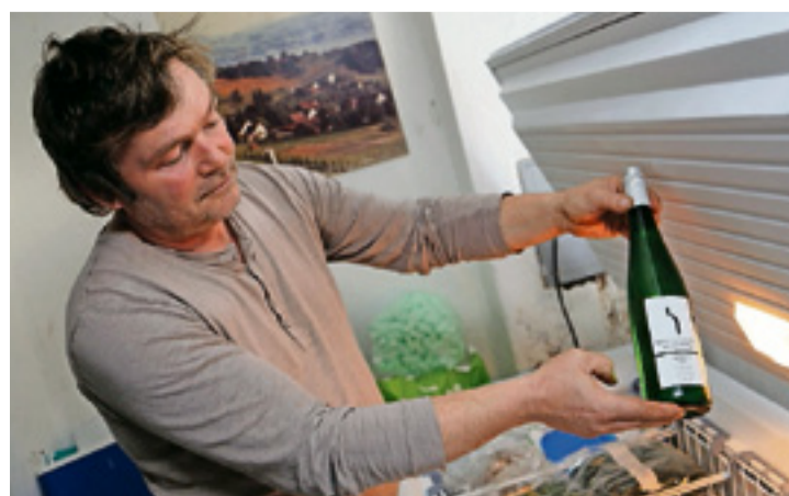
Reto Honegger prüft an einer Testflasche aus dem Tiefkühler, ob und wie stark sich unter der Kältesimulation Weinstein abgelagert hat. David Baer
