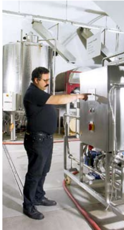
Kellermeister Kuster steuert per Touch-screen den Crossflow-Filter der Staatskellerei Rheinau
