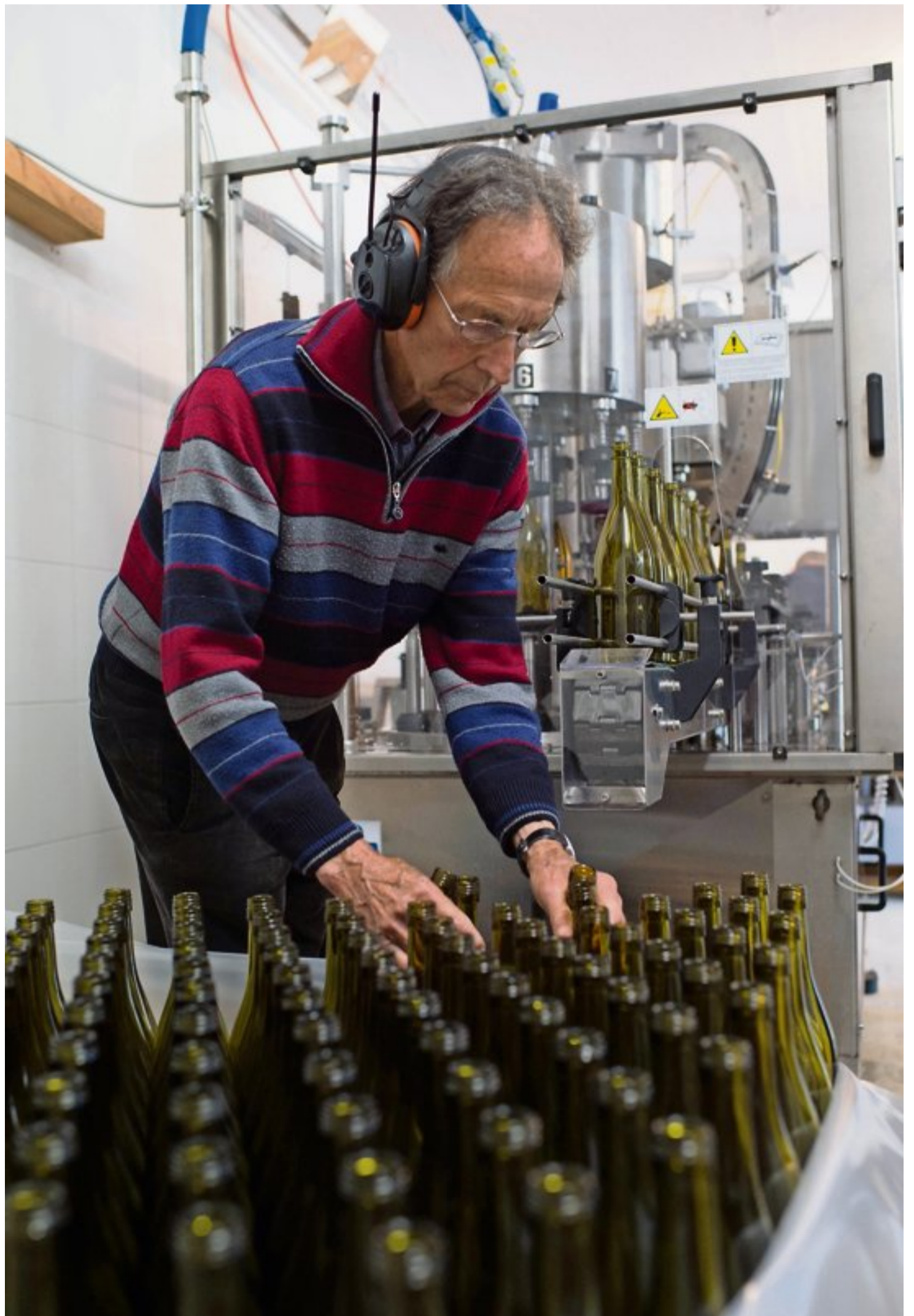
Handarbeit, bevor die Maschine übernimmt: Hansueli Hasler füttert die Abfüllanlage mit den leeren Flaschen.
